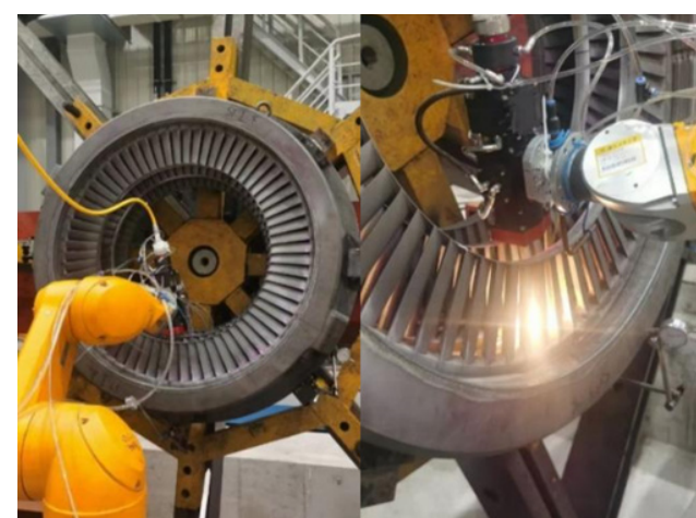
汽轮机持环的激光现场精密修复
